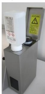
Retirez le bouchon à vis du réservoir à recharger. Vissez-y la recharge encore scellée. Le sceau du flacon sera rompu lors du vissage. La vanne d'obturation du réservoir s'ouvre automatiquement et le réservoir se remplit du contenu du flacon. Le flacon ne doit pas être retiré avant d'être entièrement vidé.
