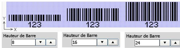
Type de code barres Code 39 à configuration variable de **<Hauteur de barre>**.
