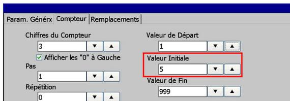
Le contenu d'un objet compteur est initialement déterminé dans le menu des paramètres d'objet. La variable pour le **<Champ d'invite>** est la valeur d'initialisation.
