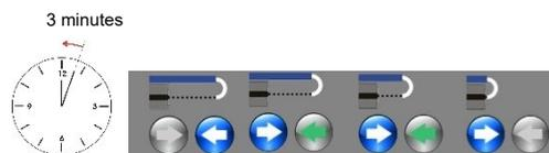
Au bout de 3 minutes sans réception d'un signal PrintGo, la buse se ferme automatiquement.
